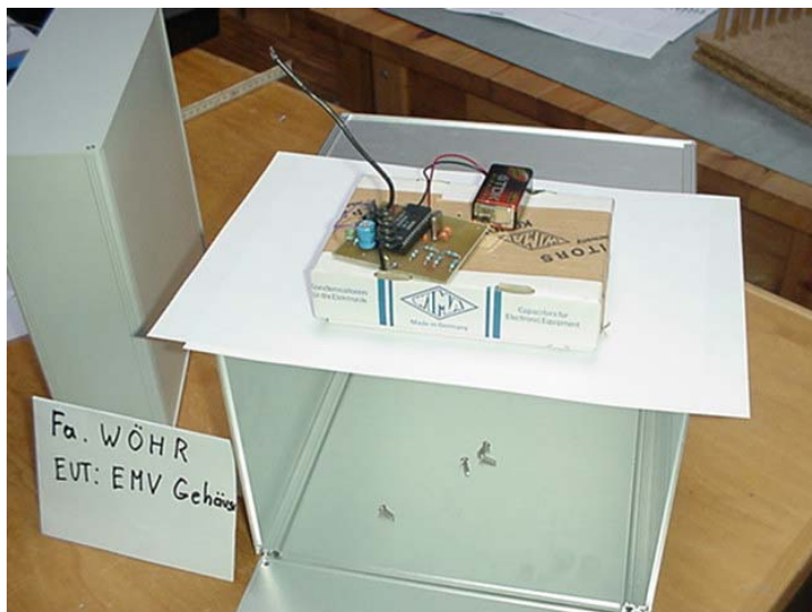
EMV-Gehäuse mit Kleinsender (außerhalb des Gehäuses)
